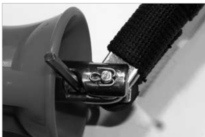
Fig. 15h Asegúrate que el pasador está bien doblado al igual que en la foto para evitar riesgo de lesiones.
