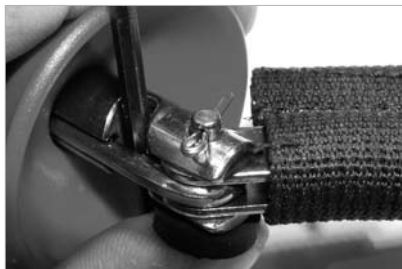
Fig. 15b Bloquea el disparador con una llave Hallen e inserta el pin en la ranura.
