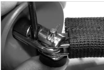
FIG. 15B Blocca la maniglia di sgancio con la chiave a brugola ed inserisci la coppia.
