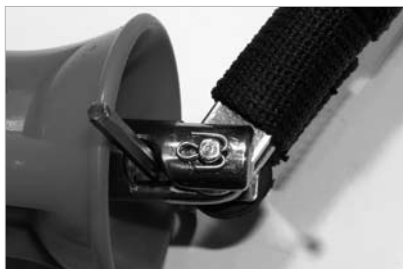
FIG. 15H Assicurati che la coppiglia sia piatta come mostrato nella figura. La coppiglia deve essere piatta in modo da evitare ogni rischio di ferimento.
