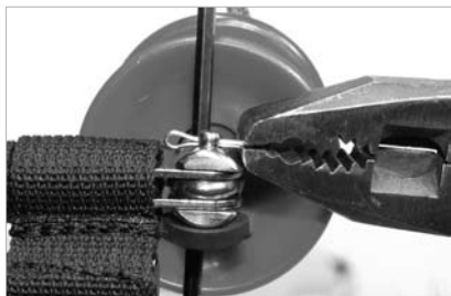
FIG. 15C Mantieni la parte lunga della coppia e tirala avanti con l'aiuto di un paio di pinze.
