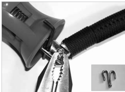
FIG. 14A Premi la maniglia di sgancio su e assicurala con la chiave a brugola. Appiattisci la testa della coppiglia con un paio di pinze (immagine piccola).
