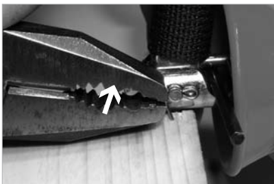
FIG. 15F Metti la fine della coppia ad un angolo appropriato, es. su una tavola di legno come mostrato sopra, e curva la coppia il più possibile.
